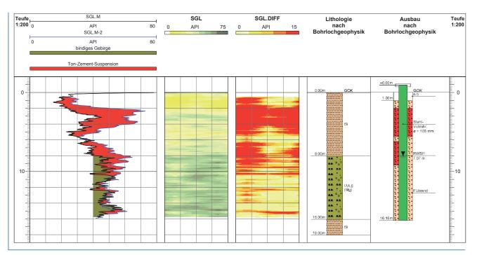
Abb. 4 - Beispiel einer geophysikalischen Verpresskontrolle nach sekundärer Ringraumverpressung über Lanzen; Aus den Messungen ist deutlich ersichtlich, dass in den geplanten Verpresshorizont nur einseitig und auch nur in den oberen Bereich Suspension gelangte. Die Verpressung muss in jedem Falle durch das Setzen weiterer Spüllanzen ergänzt werden.
