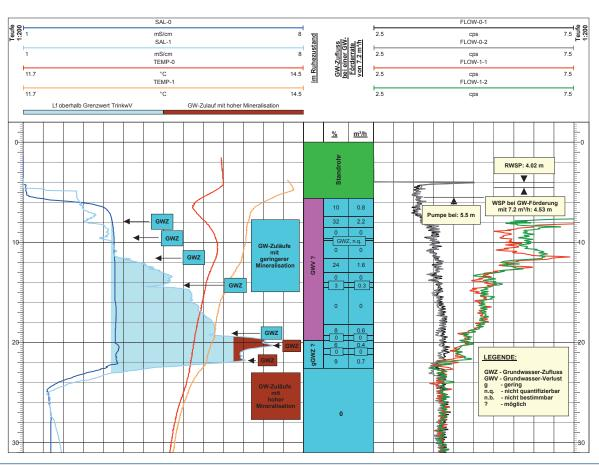
Abb. 3 – Zuflussprofil einer Aufschlussbohrung (Festgestein); In diesem Fall konnte anhand von Messungen der elektr. Leitfähigkeit des Wassers in Kombination mit Flowmetermessungen der Anschnitt von Wässern unterschiedlicher Mineralisation (Kontamination!) nachgewiesen werden. Auf der Grundlage dieser Messungen ist zur Charakterisierung der anströmenden Wässer zusätzlich eine teufenorientierte Wasserprobenahme (TP) zu empfehlen.
